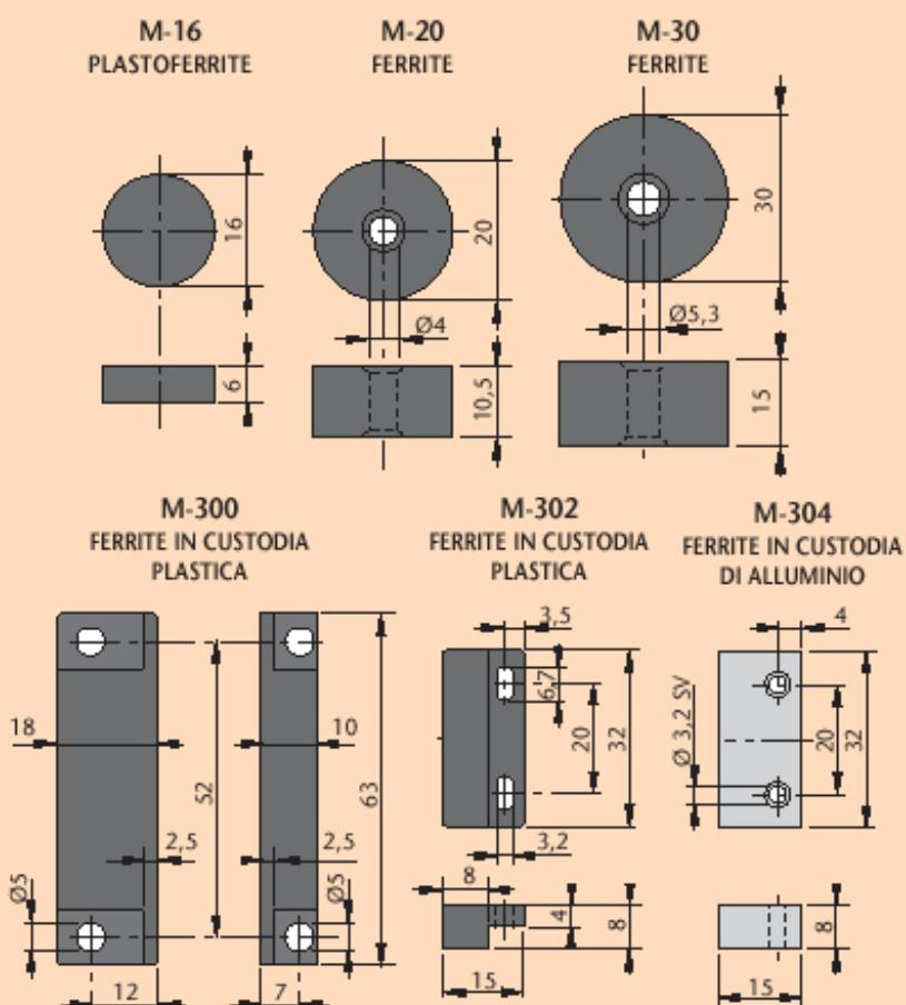
N.B.: A richiesta sono disponibili magneti di diverse dimensioni. Il modello M-300 è fornibile senza custodia plastica, solo ferrite mod. M-300F dim. 39 x 15 x 8mm.
